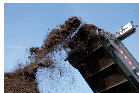
Udkasthøjde på 4400 mm.
