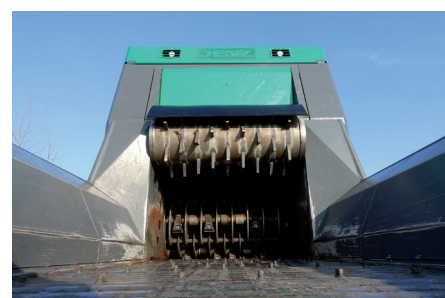
Lastelængde 4,40 m og ifyldåbning på 900 mm.
