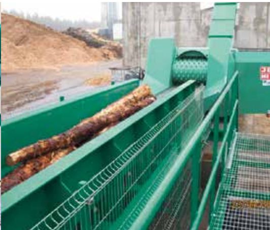
6. Sammelband unter Einzugs und Hacker Collecting belt under infeed and chipper
