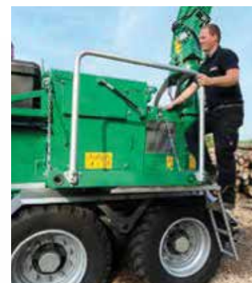
Klapbar vedligeholdelsesplatform ved soldets afdækning
