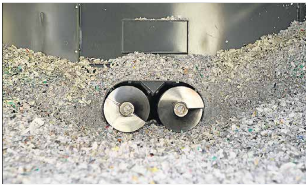
Her store snegle skubber det makulerede papir fra makulatoren ud i lastrummet. Når hele lastrummet er fyldt, hjælper et walking-floor gulv med at tømme traileren for papirrester.
