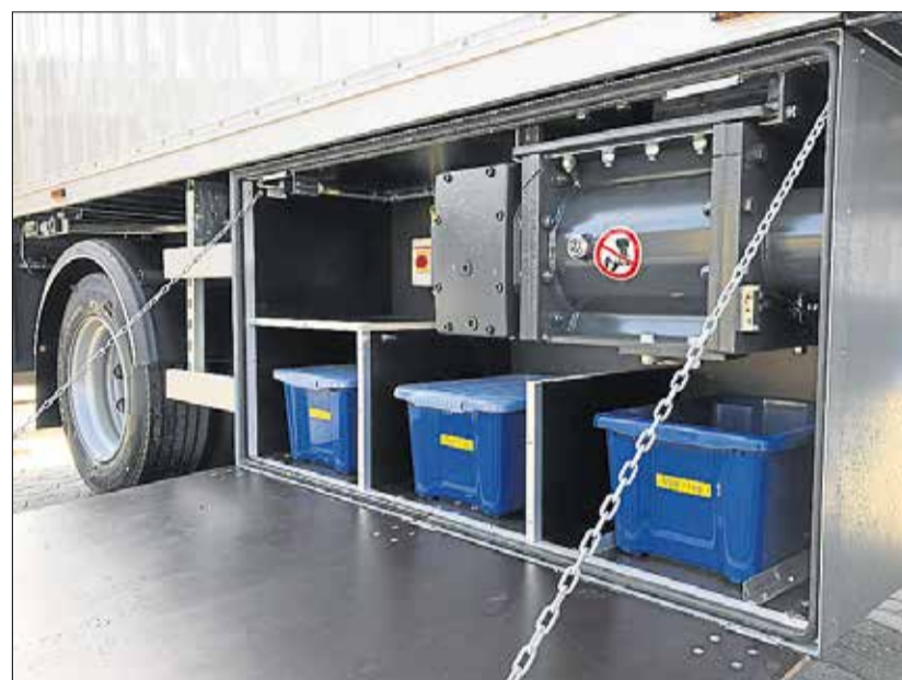
En harddisk-shredder er indbygget i siden. De makulerede harddiske falder ned i de blå plastspande og genbruges som jern- og metalkrot.
