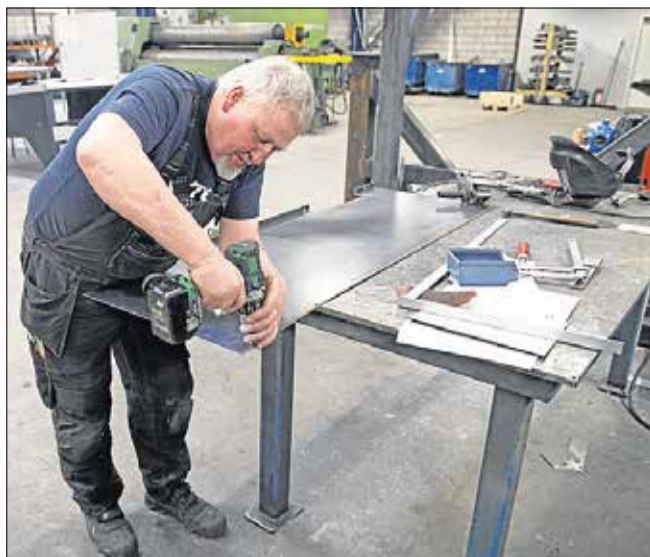
Kaj Feddersen er ved at bore huller på alu-siderne, så de kan sættes på traileren.
